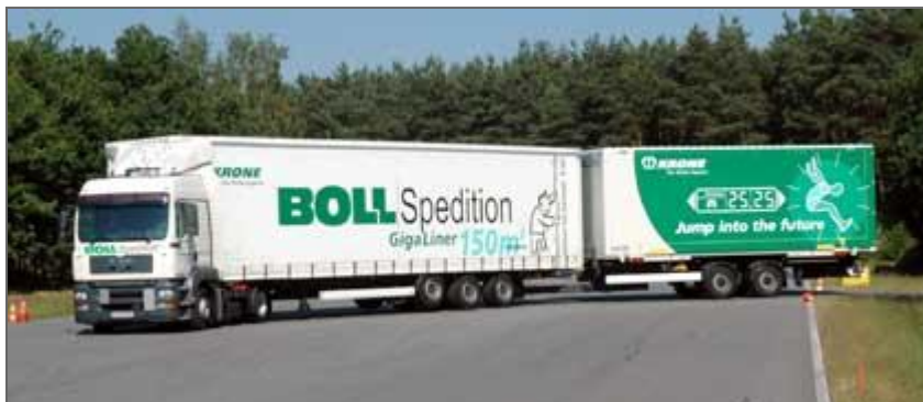
Monster-Truck: Niedersachsen erprobt die bis zu 25 Meter langen Sattelzüge
