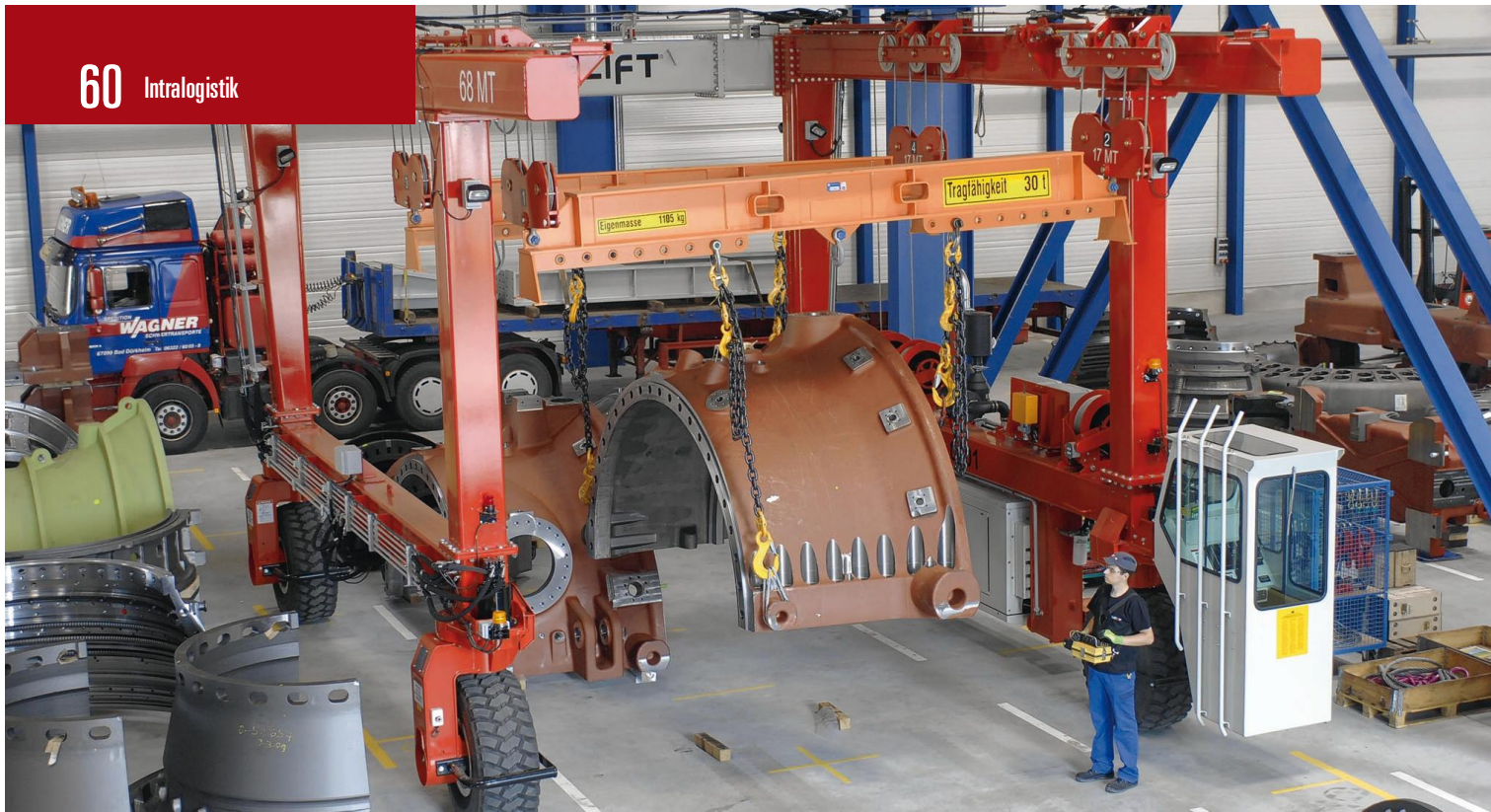
Ein Mitarbeiter im Alstom-Logistikzentrum in Mannheim bedient einen sogenannten Gantry-Kran. Der von den Mitarbeitern als „größtes Spielzeug der Welt“ bezeichnete Helfer hebt Lasten von bis zu 67 Tonnen. Das neue Logistikzentrum ist die Schnittstelle für die rein- und rausgehenden Schwergüter. Bild: Alstom
